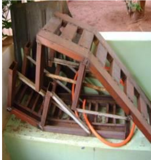
Elevador para exame pericial de chassis de veículos improvisado pela Equipe de Perícias EPC Andradina UR-15
