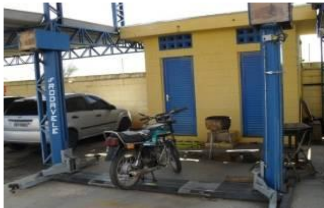
Elevador para vistoria de veículos em local descoberto. EPC Tupã UR-18
