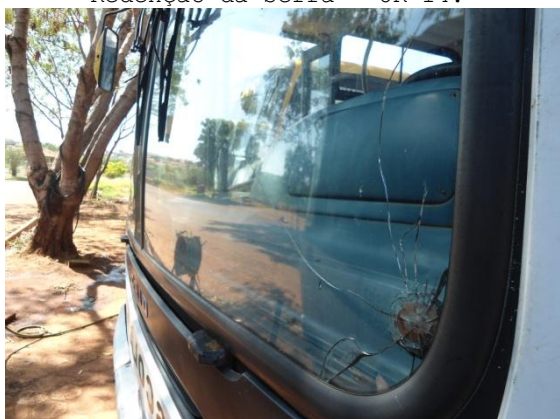
Vidro trincado. Veículo placa DBA 1989. Ilha Solteira - UR 15.
