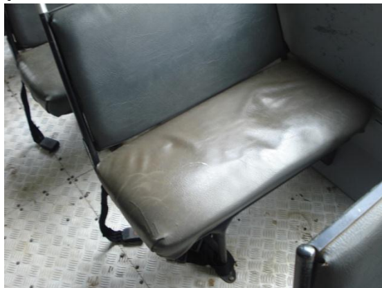
Inexistência de local para travamento do cinto. Veículo fretado, placa BTA 0620. Bragança Paulista - UR 3.
