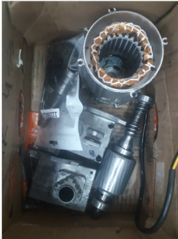
Foto 1 – Motor da cancela desmontado.
