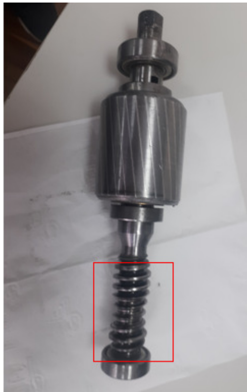
Foto 2 – Induzido com desgaste na rosca infinita do eixo do motor.
