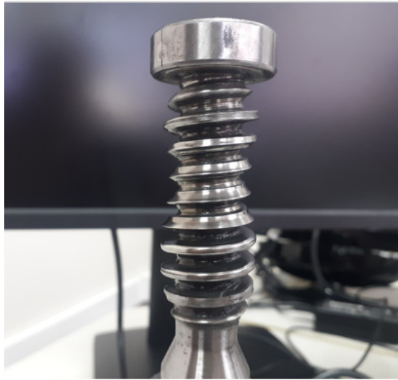
Foto 3 – Detalhe da rosca desgastada.
