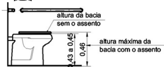
Figura 3 - Adequação de altura da bacia sanitária
